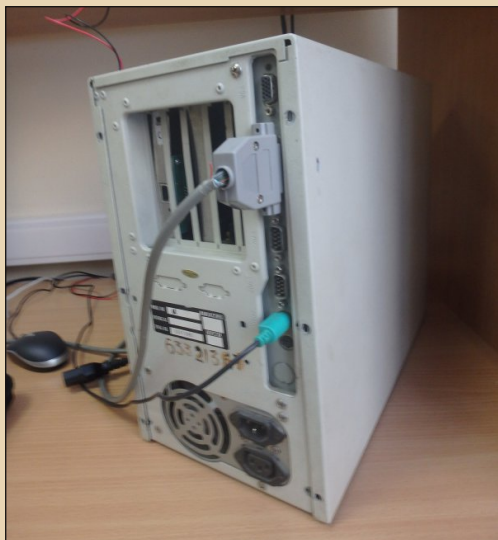
Рис. 3. Вид сзади – собственно, всё то же самое, что мы привыкли видеть на брендовых системных блоках LPX, но повернуто на 90 градусов
